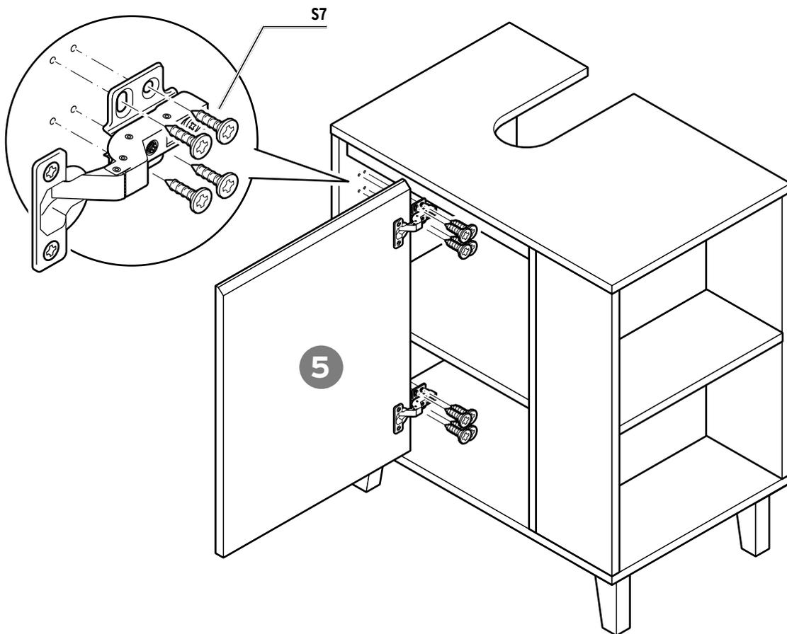
Tür ausrichten | Régler la porte | Regolare l'anta | Adjusting the door | Nastavení dvířek
